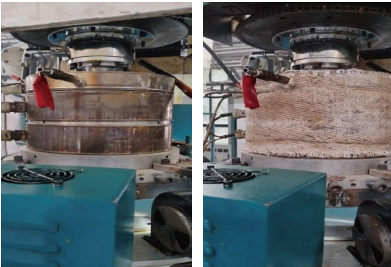
图注：裸露的加热装置（左），包覆隔热层的加热装置（右）
